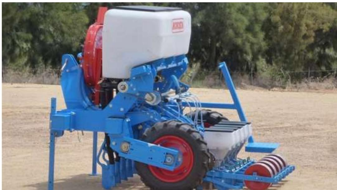
Для дозированной подачи семян из бункера к рабочим органам применяются различающиеся по конструкции механические или пневматические системы. Механические системы зачастую представлены катушечными дозаторами штифтового
