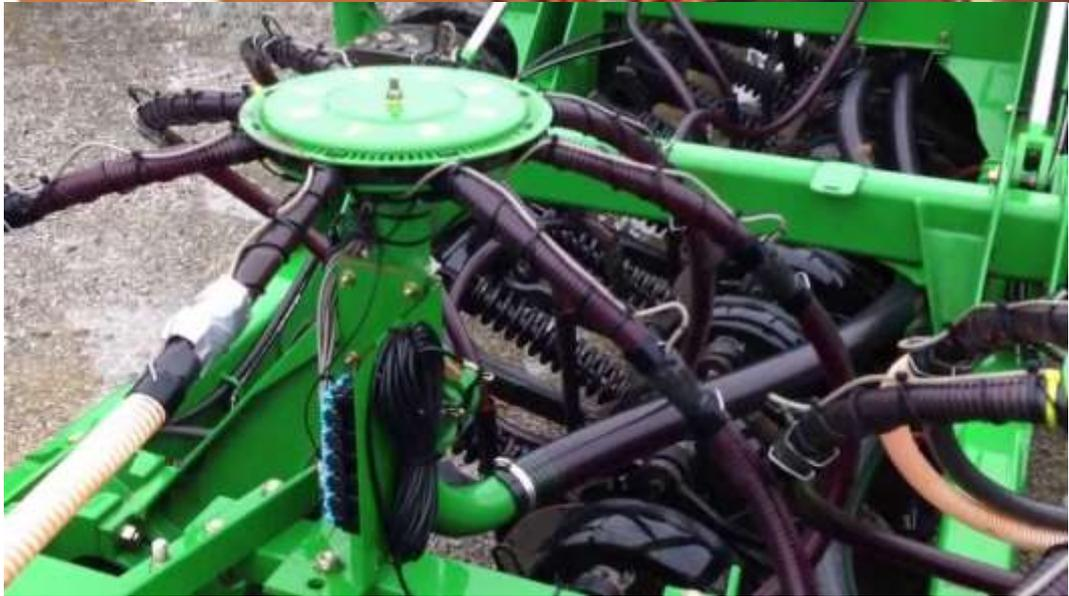
В пневматических системах семена транспортируются воздушным потоком, который разделяет их на равные части в делителе, и подаются к сошникам.
