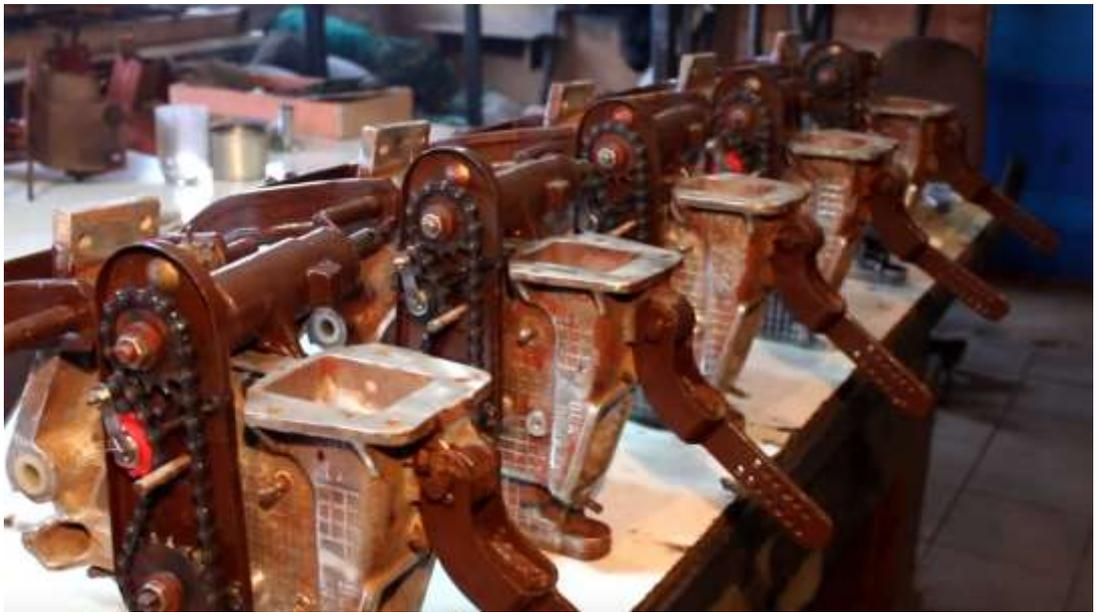
Изношенные отверстия под резьбовые соединения зачищают для последующей установки дополнительных шайб под гайки. Выступающие части шплинтов загибают, чтобы не допустить перекоса прокладки в момент установки. После сборки высевающего аппарата необходимо убедиться в качественной работе всех элементов и в натяжении приводных цепей.
